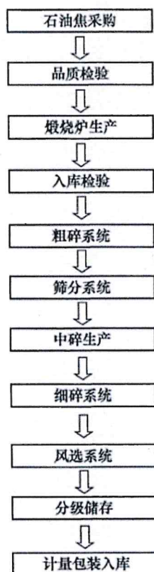
图 A.1 煅烧石油焦炭生产工艺流程示意图
